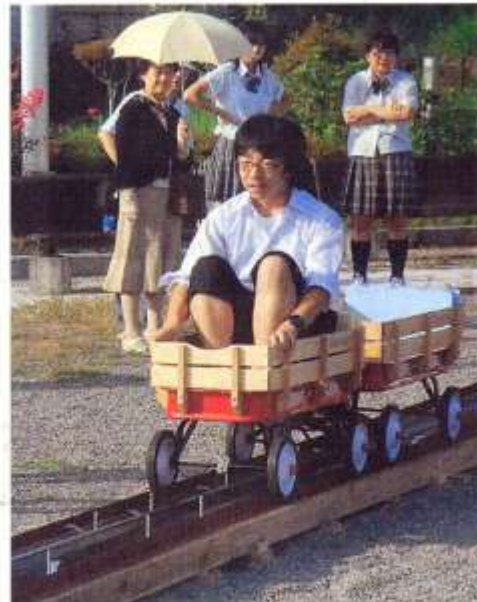
生徒らが千葉大の協力で製作した大気圧鉄道
