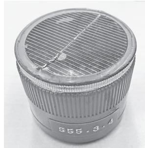
写真1：上部のソーラーパネルを回転する小型モーター
